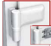
**+** Paumelle Dr Hahn réglable 3D (↑ / ↓ ↔ / compression) Grande résistance à la charge, jusqu'à 120 kg. **Fonction anti-dégondage.**
