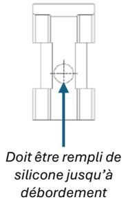
Doit être rempli de silicone jusqu'à débordement
