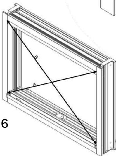
Contrôle:  $A = B (\pm 5\text{mm}) \rightarrow$  dormant d'équerre
